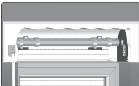
30. Clipser les cintres en les tordant et en les insérant dans les trous du tube.
