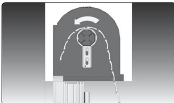
29. Passer le rideau dans le tube d'enroulement, bord inférieur avec le joint vers le bas, comme indiqué sur l'image ci-dessus. Avant de glisser le rideau, fixer le tube d'enroulement pour éviter d'endommager le profilé.
