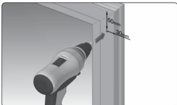
6. Sur la fenêtre, déterminer les emplacements pour le montage des vis de fixation (mamelons) en mesurant et en marquant les distances susmentionnées à partir des bords du cadre. Monter les vis (mamelons) tous les 50 cm en moyenne, mais pas moins de 3 par côté et à 5 cm du bord inférieur et supérieur du cadre de la fenêtre.
