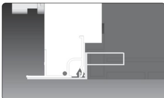
32. Vue d'un profilé de montage correctement installé.
