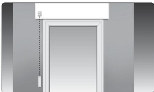
22. Veiller à ce que le trou pour la roue d'enroulement soit situé verticalement par rapport à la sortie de bande du boîtier d'obturation.
